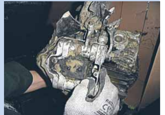
Wnętrze cylindra silnika PZL Bristol „Pegaz” (fot. autora)
