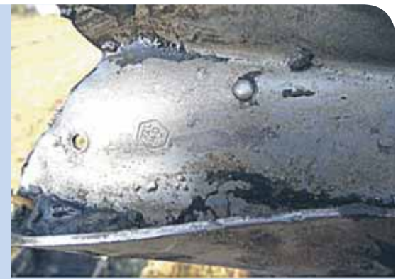
Bicie odbioru technicznego Polskich Zakładów Lotniczych na części płatowca „Łosia” (fot. autora)
